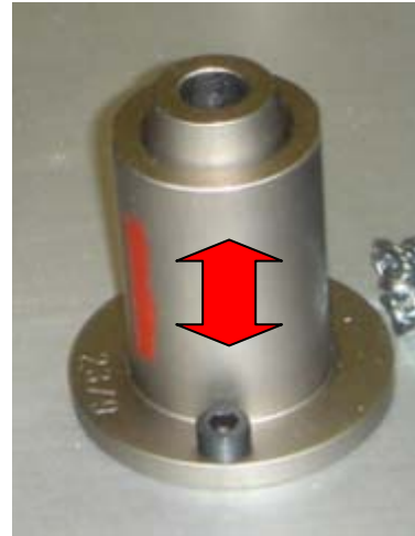
Centreur conique, permettant de centrer la pièce par l'un de ses trous ; la forme du centreur permet d'absorber la tolérance de fabrication du trou, et d'assurer ainsi un centrage optimum.
